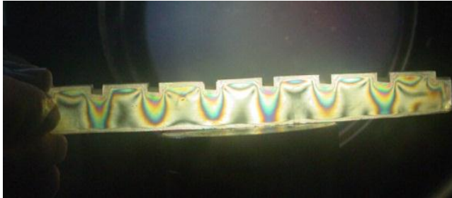
G.中支承辊与底座接触的切片图
