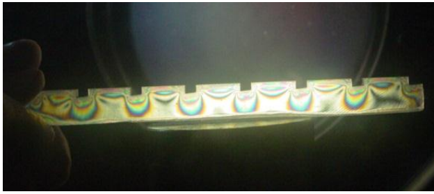
E.中支承辊与左中间辊接触的切片图
