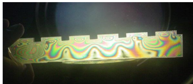
D. 左支承辊与底座接触的切片图
