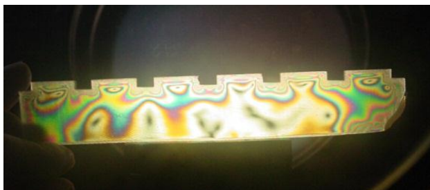
C. 左支承辊与左中间辊接触切片图
