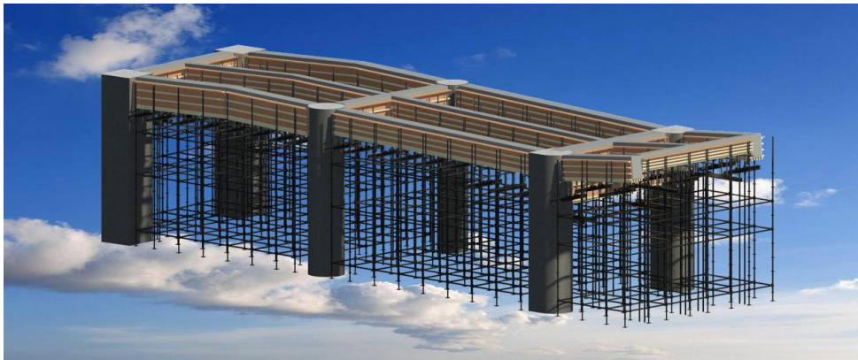
图 4 承插型盘扣式钢管支撑体系
