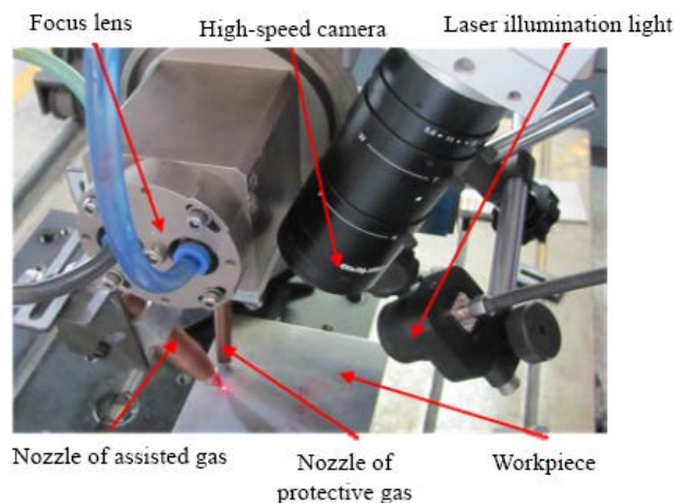
图 5 激光焊接过程监测系统
