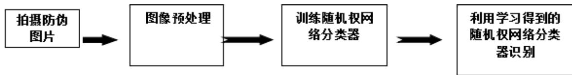
图 2 本文提出的卷烟激光打码防伪识别算法的流程图
